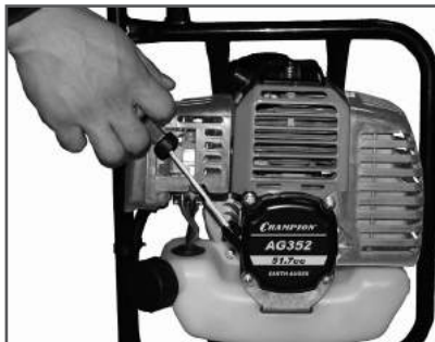
Рис. 7 Свободный ход шнура стартера
