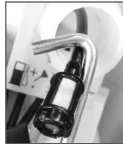
Рис. 12 Извлечение топливного фильтра
