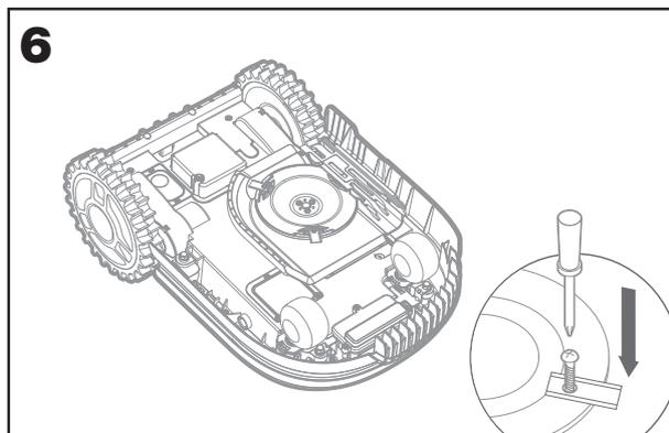
**⚠ Внимание:** При установке новых ножей убедитесь, что вы заменили ВСЕ ножи. При установке ножей всегда используйте новые винты. Это важно для обеспечения фиксации ножей и балансировки поворотного ножевого диска. Неиспользование новых винтов может повлечь за собой серьезную травму. Важно! После прикручивания ножа к ножевому диску убедитесь, что нож свободно вращается.
