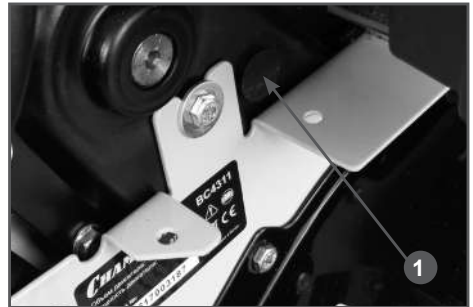
Рис. 22 Расположение пробки отверстия для добавления смазки в редуктор
