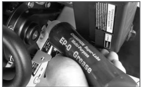
Рис. 23 Добавление смазки в редуктор
