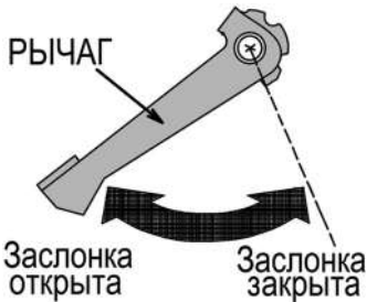
Рис. 11 Рычаг управления воздушной заслонкой (вид сверху)
