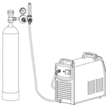
Рисунок 8.5. Подключение защитного газа.
