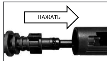
Рис. 6 Подсоединение струйной трубки к пистолету
