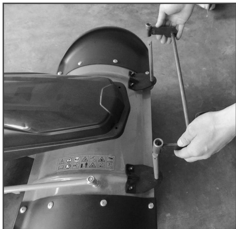
Рис 3. Установка промежуточной скобы
