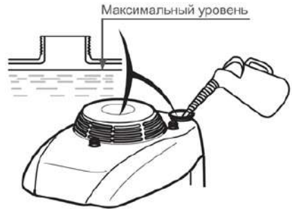
Рис. 14. Максимальный уровень топлива в топливном баке
