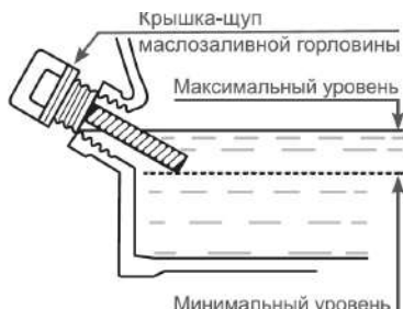
Рис. 13. Уровень масла в картере двигателя 6. Плотно закрутите крышку-щуп.
