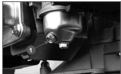
Рис. 20. Слив топлива с поплавковой камеры карбюратора
