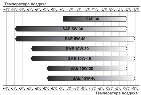
Рис. 11. Определение вязкости масла
