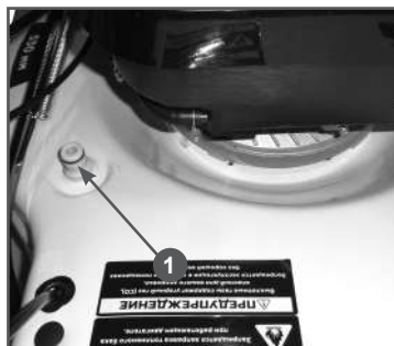
Рис. 29 Расположение коннектора для подключения шланга
