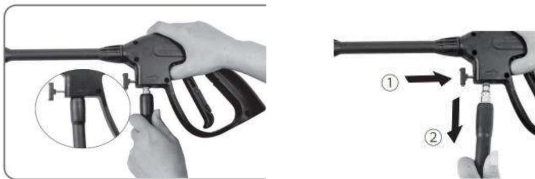
8. Снимите пластиковую заглушку со входного соединительного разъёма для воды. Закрутите фитинг на входе воды, затем вставьте быстроразъемное соединение (1/2 дюйма) во входной соединительный разъём для воды. Затем подсоедините один конец домашнего садового шланга (не входит в комплект) к быстроразъемному соединению. Подключите другой конец шланга к источнику воды.
