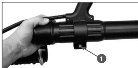
Рис. 4 Установка рукоятки управления
