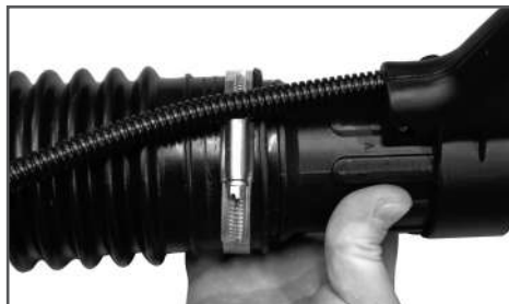
Рис. 5 Установка трубы напорной «А»
