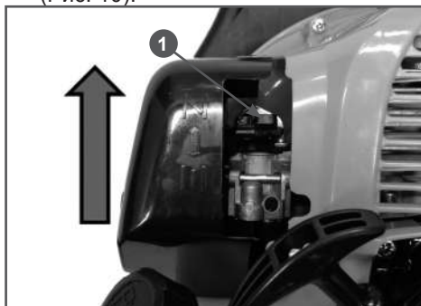
Рис. 10 Воздушная заслонка карбюратора закрыта
