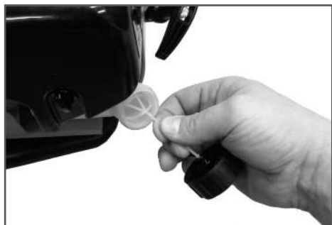
Рис. 14 Снятие крышки топливного бака
