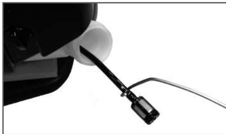
Рис. 15 Извлечение топливного фильтра
